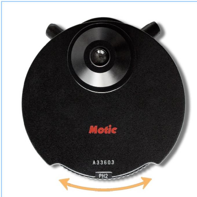
Es empfiehlt sich dann die Anschaffung des Universalkondensators von Motic. Dieser ermöglicht die Beobachtung im Hellfeld (alle Objektive), Phasenkontrast (alle Objektive) und Dunkelfeld (Objektive 10x/20x/40x). Möglich wird dies durch die spezielle Revolverkonstruktion dieses Kondensators. Auf einer Revolverscheibe befinden sich alle verfügbaren Phasenkontrastblenden (PH1/PH2/PH3), eine Dunkelfeldblende (DF), sowie eine Leerstelle für die Hellfeld-Mikroskopie (BF).
