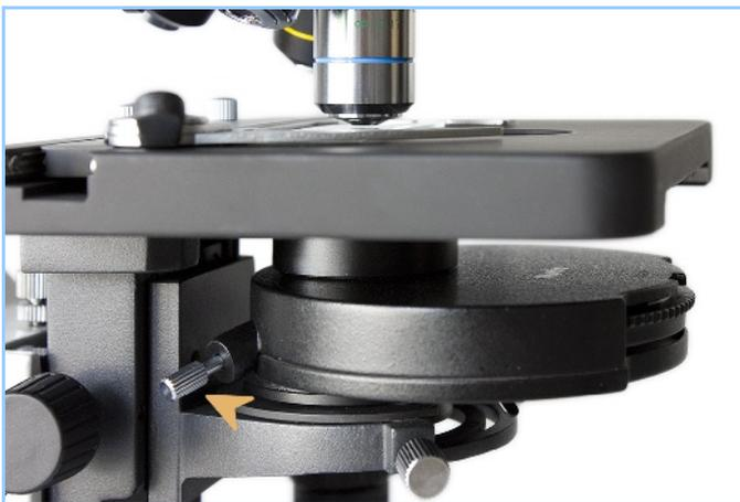
Bevor mit dem Universalkondensator das gewünschte Kontrastverfahren eingestellt werden kann, müssen die Blenden zentriert werden. Dies erfolgt nach der Montage des Kondensators am BA310. Hierzu wird der Kondensator mit zwei Zentrierschlüsseln ausgeliefert, die in die beiden rückseitigen Aufnahmen des Kondensators eingeführt werden (siehe Pfeil in der Abbildung links). Die Zentrierung erfolgt dann in der gleichen Weise wie bereits für die Phasenkontrast- und Dunkelfeldschieber beschrieben.
