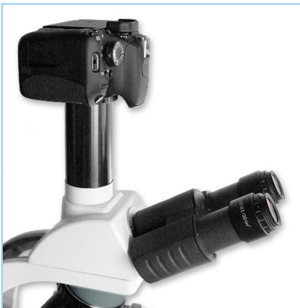
Dieser Adapter ist für die Anbringung von Systemkameras mit Sensoren im APS-C-Format konzipiert (typischerweise digitale Spiegelreflexkameras - „DSLR“). Am oberen Ende besitzt der Adapter ein Gewinde nach dem Standard „T2“. Für die Anbringung einer bestimmten Systemkamera muss diese über den kameraspezifischen T2-Adapter mit dem DSLR-Adapter 1,6x verbunden werden.
