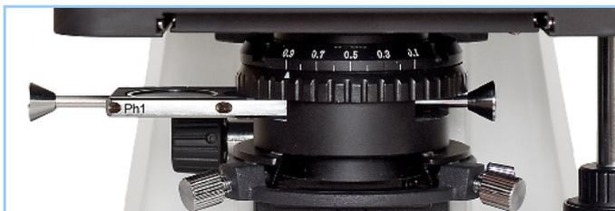
Die Zentrierung der Ringblende erfolgt mittels zweier Inbusschlüssel (im Lieferumfang enthalten). Um die zugehörigen Zentrierschrauben des Schiebers zu sehen empfiehlt es sich, beim Anbringen der Inbusschlüssel jeweils leicht von der Seite auf den Kondensator zu blicken.
