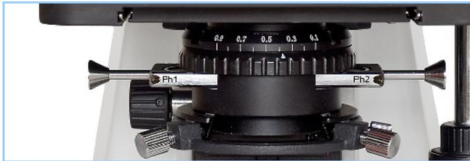
Zunächst befindet sich der Phasenschieber noch in der Position für die konventionelle Durchlichtmikroskopie, welche zur Abgrenzung vom Phasenkontrast auch als „Hellfeld“ bezeichnet wird. Dabei befindet sich die Leerstelle des Schiebers im Strahlengang (Abbildung links). Die Aperturblende ist auf eine Beleuchtungsapertur von knapp 0.4 eingestellt.
