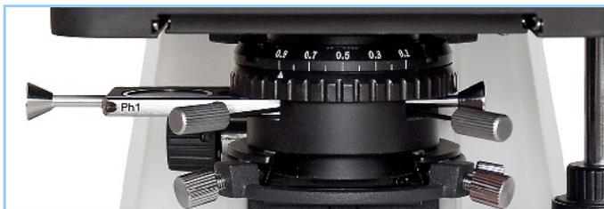
Um zum Phasenkontrastverfahren zu wechseln wird die rechte Ringblende (Aufschrift „Ph 2“) in den Strahlengang gebracht. Der Schieber rastet hierbei deutlich ein. Zur Vermeidung von Störungen bei der Bildentstehung wird die Aperturblende völlig geöffnet. Blickt man nun durch das Mikroskop, wird man vermutlich ein Bild ähnlich der Abbildung rechts sehen. Der Phasenring ist nicht richtig zentriert und die Objekte sind typischerweise einseitig aufgehellt.
