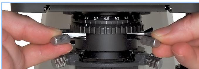
Durch Drehen an den Inbusschlüsseln wird erreicht, dass sich schließlich ein Bild wie rechts dargestellt zeigt. Die Ringblende ist dann zentriert. Die gleiche Vorgehensweise muss dann noch mit dem Phasenkontrastobjektiv 10x in Kombination mit der zugehörigen kleineren Ringblende „Ph1“ erfolgen.
