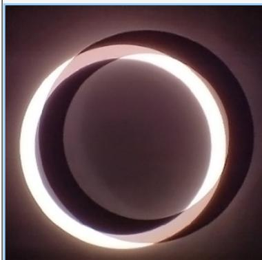
Links: Blick durch das Zentrierteleskop vor der Justierung der Phasenblende. Der dunkle Ring ist der Phasenring im Objektiv, der helle Ring wird durch das von der Ringblende kommende Licht geformt.
