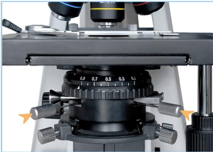
Der Blendschieber wird nachfolgend in die Position für Dunkelfeld gebracht (linke Rastposition). Dann öffnet man sowohl die Apertur- als auch die Leuchtfeldblende des Mikroskops komplett. Nun kann man die beiden mitgelieferten Zentrierschlüssel in die beiden Öffnungen an der Vorderseite des Schiebers einführen und den eigentlichen Zentriervorgang durchführen.
