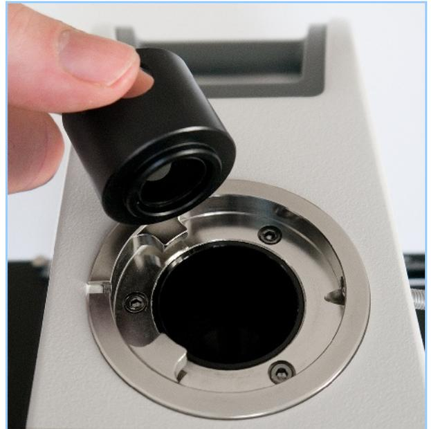
Wie bereits erwähnt wird das linear polarisierte Licht durch den Analysator nur dann absorbiert, wenn dieser sich in Kreuzstellung zum Polarisator befindet. Um diese Kreuzstellung zu erreichen dreht man den Polarisator einfach so lange in seiner Aufnahme auf dem Mikroskopfuß, bis der Bilduntergrund so dunkel wie möglich erscheint.
